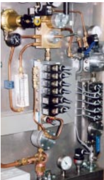
Gasmisch- und Gasverteilstation für einen Aluminiumschmelzofen mit 13 Porössteinen
